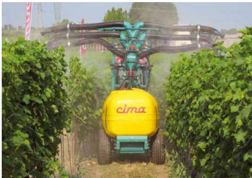
Foto sopra: atomizzatore serie LINK. È possibile abbinare svariate testate di distribuzione, destinate a diverse colture, ma tutte dotate di un inedito sistema anti-sgocciolamento brevettato, le testate si basano sul principio del Tubo Venturi che consente una nebulizzazione più fine e uniforme, pertanto di maggiore efficacia
